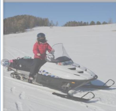
Рис. 91. Увеличение площади опоры для уменьшения давления на поверхность
